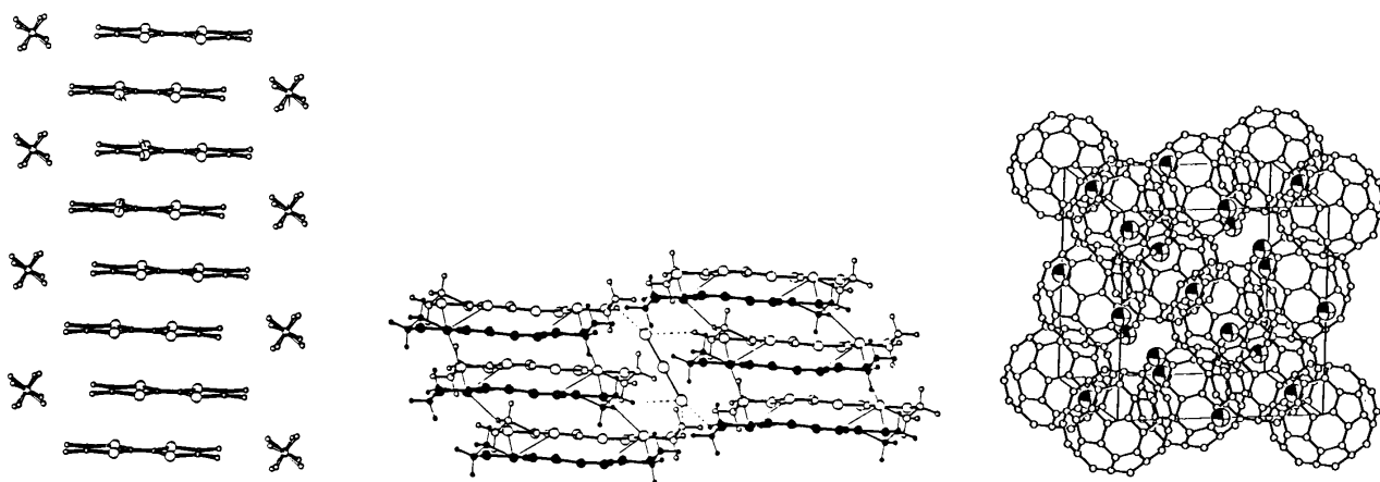
FIG. 1 – Architecture de quelques composés organiques a) quasi-unidimensionnel : (TMTSF)_2X , b) quasi-bidimensionnel : (BEDT - TTF)_2I_3 , c) tridimensionnel : K_3C_{60}
